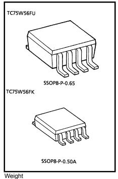
SSOP8-P-0.65 : 0.021g (typ.) SSOP8-P-0.50A : 0.01g (typ.)
