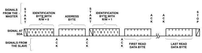
FIGURE 20. READ SEQUENCE (CSR SLAVE ADDRESS SHOWN)
