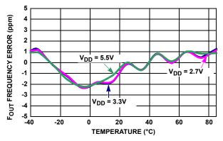
FIGURE 7. OSCILLATOR ERROR vs TEMPERATURE
