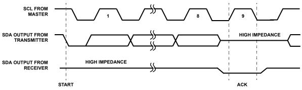
FIGURE 17. ACKNOWLEDGE RESPONSE FROM RECEIVER
