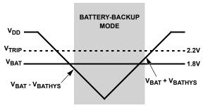
FIGURE 13. BATTERY SWITCHOVER WHEN  $V_{BAT} < V_{TRIP}$
