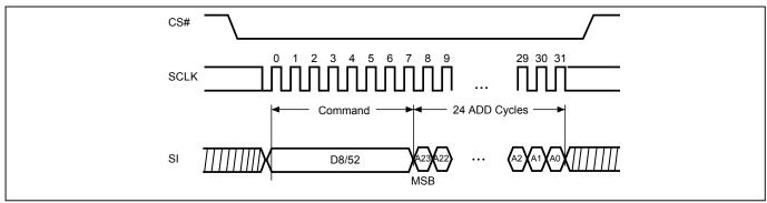
Figure 28. Chip Erase (CE) Sequence (Command 60 or C7)
