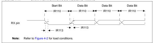
TABLE 4-7: UART ASYNCHRONOUS RECEIVE REQUIREMENTS
